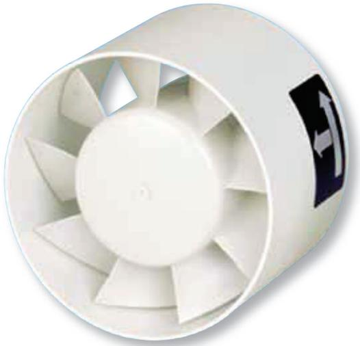
Ventiladores helicoidales para intercalar en conductos, motor monofásico 230V-50Hz, aislamiento Clase II, IPX4, con protector térmico. Pueden trabajar a temperaturas de hasta 40°C.
